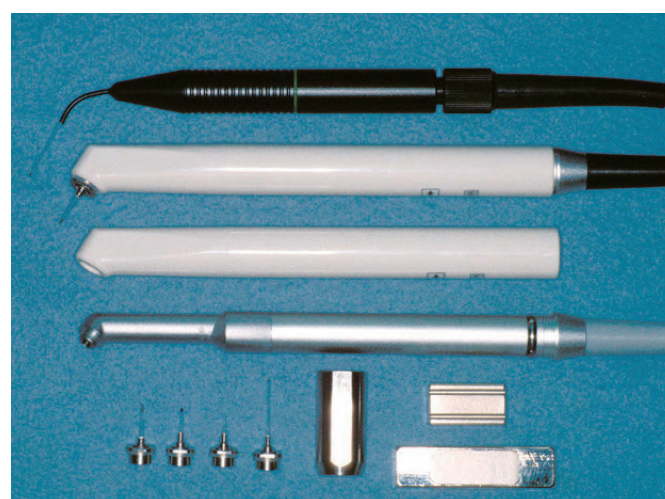
図4 従来型レーザープローブ, チップ・カバー装着型プローブ 1) .
